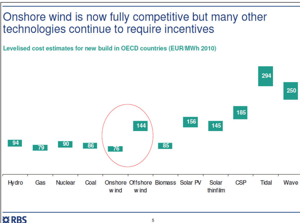
Figur 1. Vindkraftens konkurrenskraft. Detta diagram från Royal Bank of Scotland visar beräknade kostnader för ny elproduktion från olika typer av kraftverk 2010. El från vindkraftverk på land är billigast, och kostar 76 €/MWh (ett nyckeltal som visar kvoten av investeringskostnaden och den beräknade årsproduktionen).
